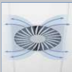
Горизонтальная подача воздуха в двух направлениях
