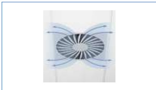
Горизонтальная подача воздуха в двух направлениях
