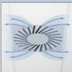
Горизонтальная подача воздуха в двух направлениях
