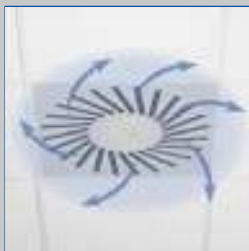
Горизонтальная вихревая подача воздуха
